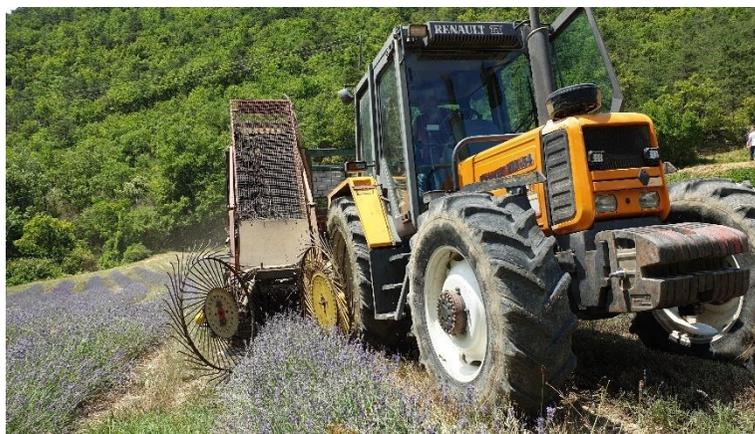
Figure 51 : coupeuse mono-rang adaptée aux terrains de montagne (source : Alain Aubanel, CIHEF).
