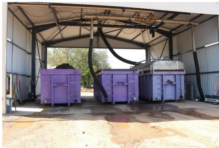
Figure 55 : distillation en caissons (source : CIHEF).
